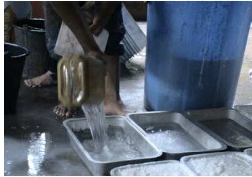
ภาพที่ 3 แสดงการผสมน้ำยางที่ต้องใส่นํ้าก่อนใส่นํ้ายาง
