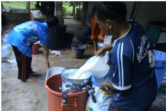
ภาพที่ 1 แสดงการใช้กรองเพื่อกรองสิ่งสกปรกออกจากน้ำยาง
