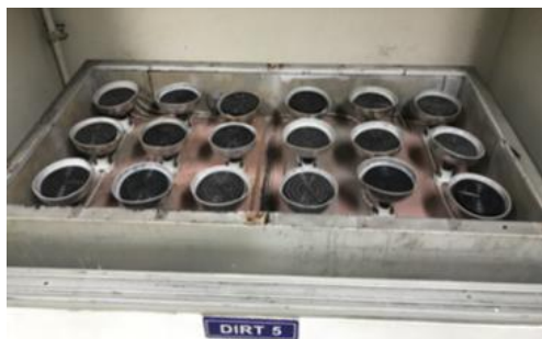
ภาพที่ 9 ฮีตเตอร์ที่ให้ความร้อนด้วยหลอดอินฟราเรด (infrared heater) แบบใหม่
