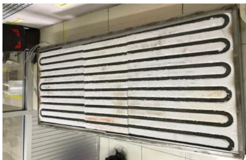
ภาพที่ 8 ฮีตเตอร์ที่ให้ความร้อนด้วยขดลวดไฟฟ้า (electric heater) แบบเดิม
