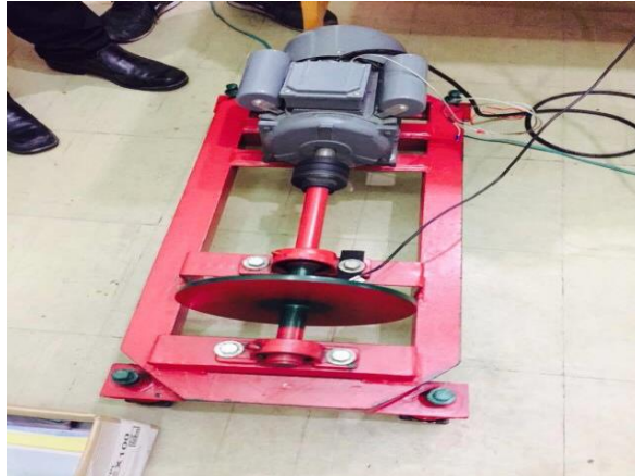
ภาพที่ 4 ชุดฝึกอบรมระบบมวล-ตัวหมุน-สปริง ที่สร้างขึ้น
