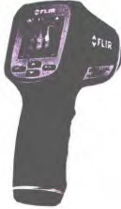
รูปที่ 7 กล้องถ่ายภาพความร้อน(Thermoscan)รุ่น FLIR TG 165
