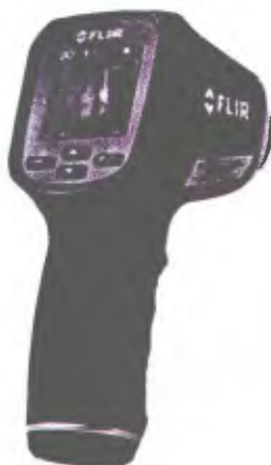
รูปที่ 4.18 กล้องถ่ายภาพความร้อน(Thermoscan)รุ่น FLIR TG 165 ที่มา http://www.thermoscan.co.th/TG165.html
