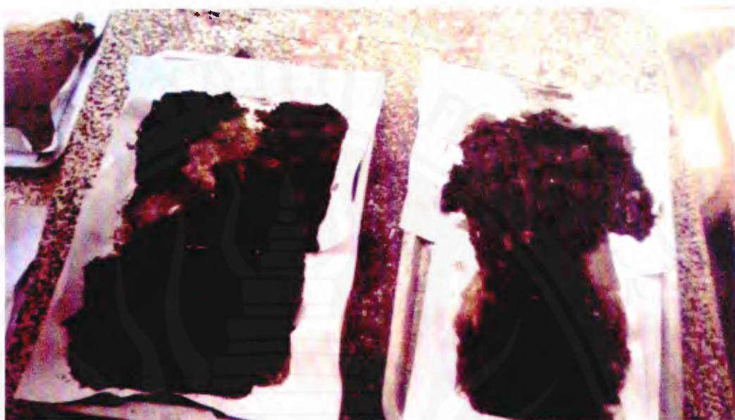
ภาพที่ 6.5 แสดงลักษณะของการตากดินให้แห้ง
