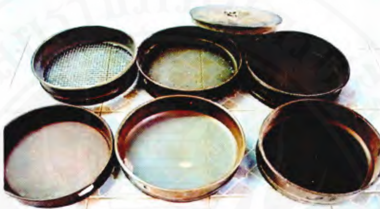
รูปที่ ค-3 ชุดตะแกรงสำหรับวัสดุที่มีเล็กกว่าเบอร์ 4
