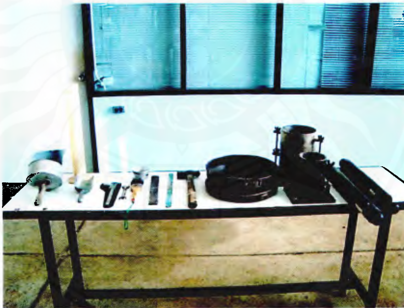
รูปที่ ค-24 อุปกรณ์ทดสอบการบดอัดดิน
