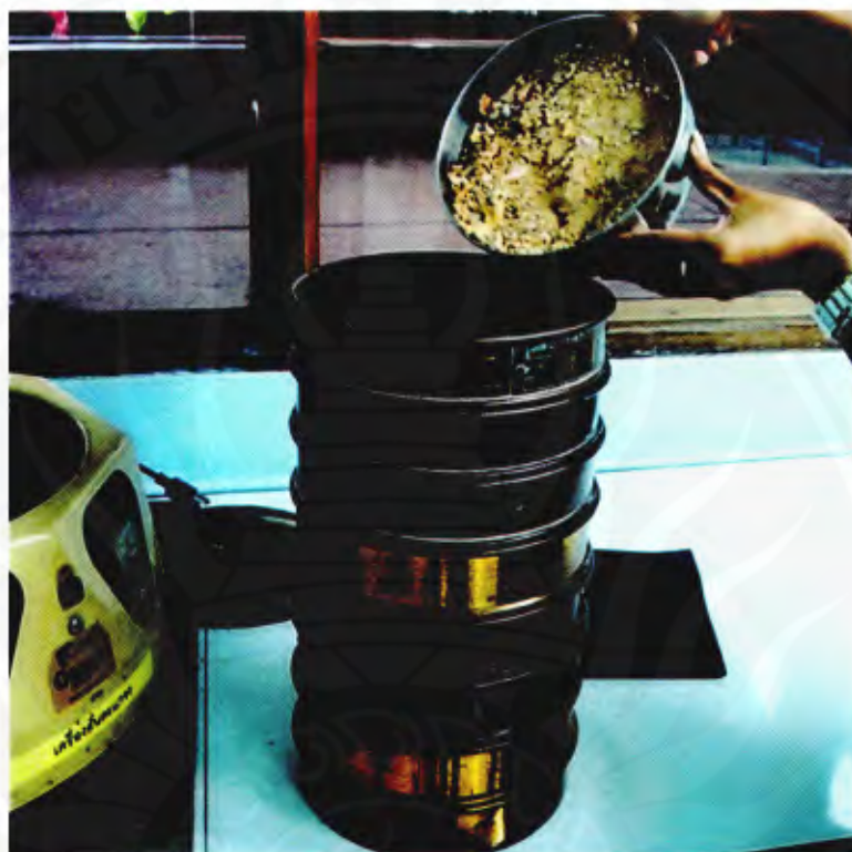
รูปที่ ค-5 เทดินที่อบแล้ว ใส่เครื่องเขย่า
