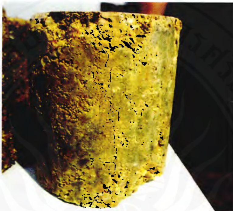
รูปที่ ค-52 ลักษณะของก้อนตัวอย่างที่ผสม Cement เมื่อรับแรงกดแล้ว
