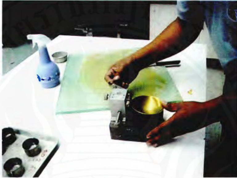
รูปที่ ค-11 เครื่องมือทดสอบ Liquid Limits (LL)
