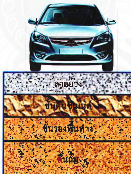
รูปที่ 5.2 โครงสร้างถนนโดยที่ใช้ดินซีเมนต์
