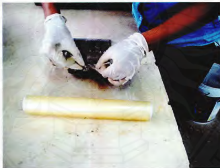
รูปที่ ค-37 นำก้อนตัวอย่างที่ออกมาหุ้มด้วยพลาสติก
