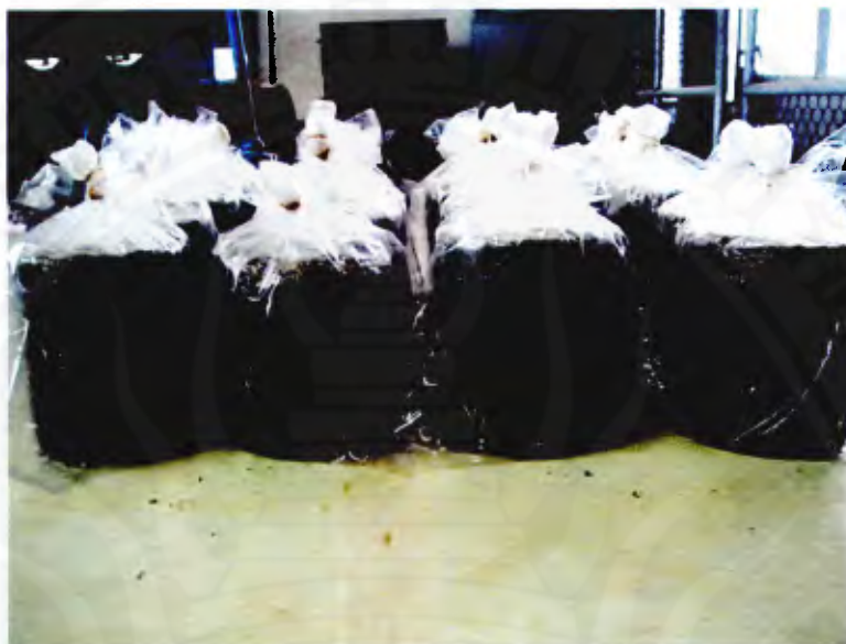
รูปที่ ค-42 ก้อนตัวอย่างก่อนบ่มที่ 9 เปอร์เซนต์ซีเมนต์
