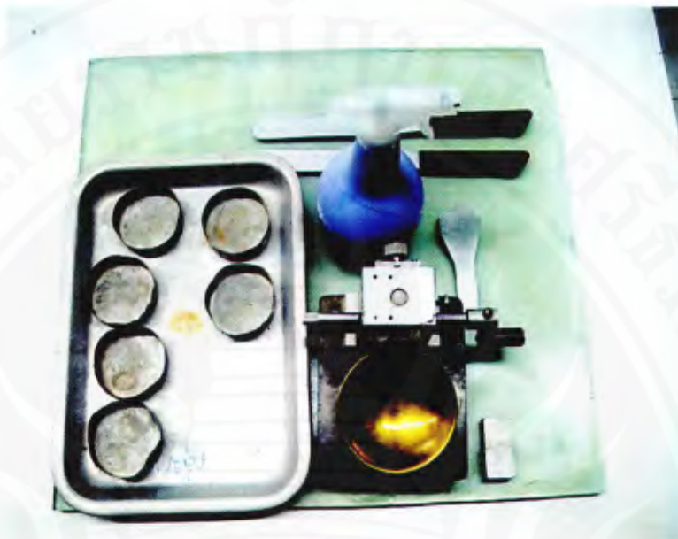
รูปที่ ข-5 เครื่องมือทดสอบ Liquid Limits (LL)
