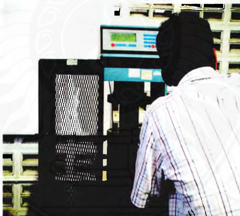
รูปที่ ข-18 วางก้อนหินคลุกบนเครื่องกด และอ่านค่ากำลังจากเครื่องกด
