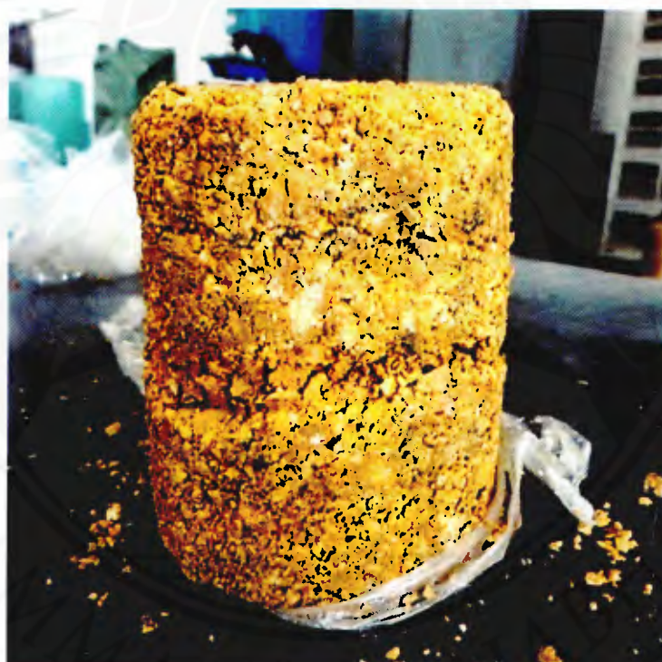
รูปที่ ค-53 ลักษณะของก้อนตัวอย่างที่ไม่ผสม Cement เมื่อรับแรงกด
