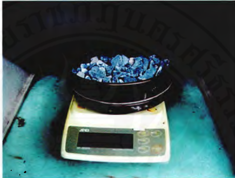
รูปที่ ข-3 ชั่งน้ำหนักของดินแต่ละตะแกรง แล้วนำไปอบ
