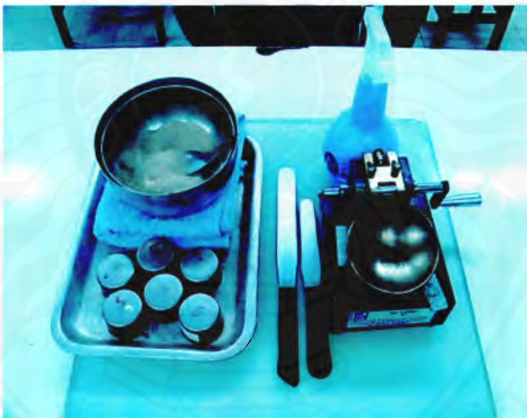
รูปที่ ค-8 เครื่องมือทดสอบ Liquid Limits (LL)
