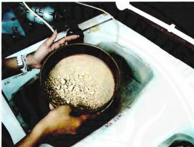
รูปที่ ค-9 ร่อนดินผ่านตะแกรงเบอร์ 40
