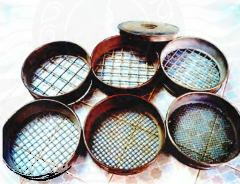
รูปที่ ค-2 ชุดตะแกรงสำหรับวัสดุที่มีขนาดใหญ่กว่าเบอร์ 4
