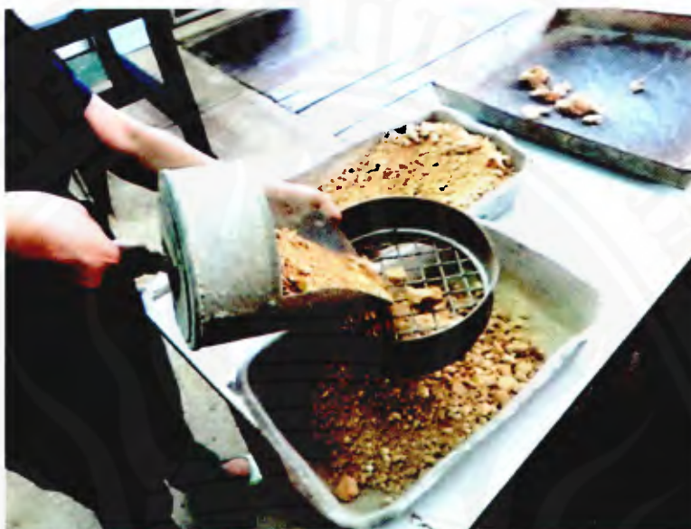
รูปที่ ค-25 การนำตัวอย่างร้อนผ่านตะแกรงขนาด 3/4 นิ้ว
