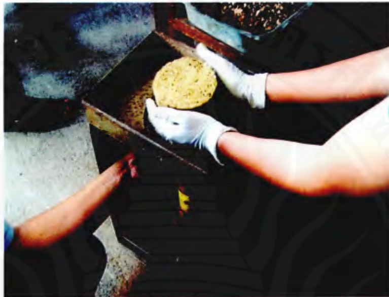
รูปที่ ค-36 ลักษณะก้อนตัวอย่างที่ดันออกจาก Mold
