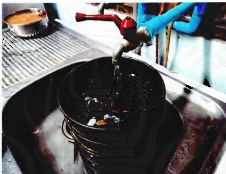
รูปที่ ข-1 เปิดน้ำผ่านตะแกรง เพื่อให้ดินเม็ดเล็ก ผ่านตะแกรงลงมา
