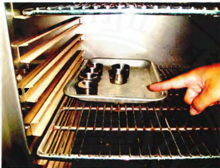
รูปที่ ก-19 การนำตัวอย่างดินไปอบในเตาอบเพื่อหาปริมาณน้ำ
