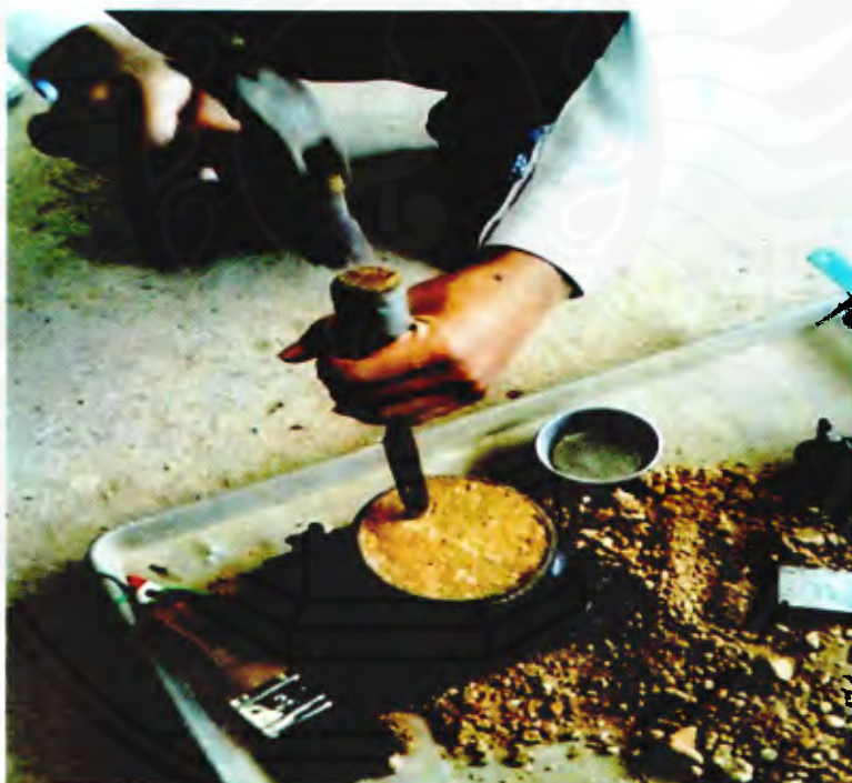
รูปที่ ค-32 การเก็บตัวอย่างเพื่อนำไปคำนวณหาปริมาณน้ำในดิน
