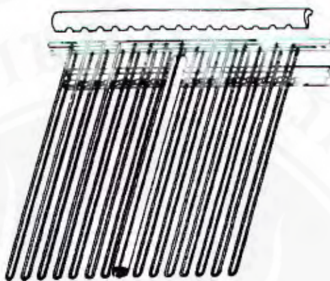
ภาพที่ 2.13 แสดงโครงสร้างของแผงรับรังสีแบบท่อแก้วสุญญากาศ ที่มา : G.L. Morrison และคณะ, 2004
