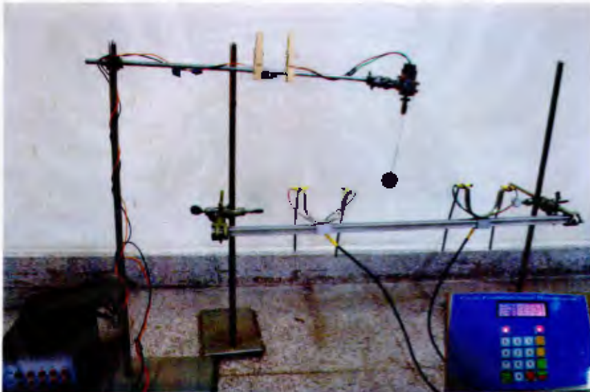
ภาพที่ 3.7 การติดตั้งชุดทดลองการเคลื่อนที่แบบวงกลม
