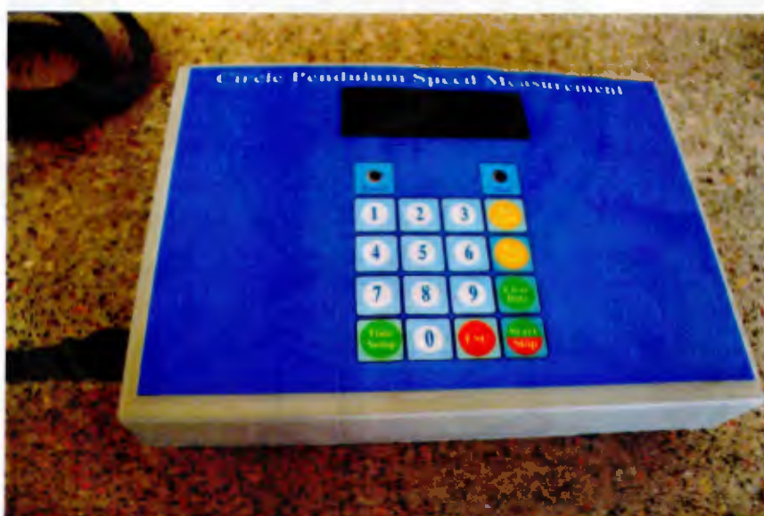
ภาพที่ 3.5 ชุดเชื่อมต่อกับคอมพิวเตอร์เรื่องการเคลื่อนที่แบบวงกลม
