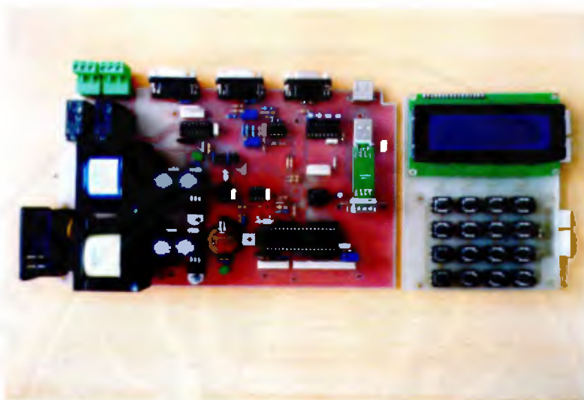
ภาพที่ 3.4 อุปกรณ์ภายในชุดเชื่อมต่อกับคอมพิวเตอร์เรื่องการเคลื่อนที่แบบวงกลม
