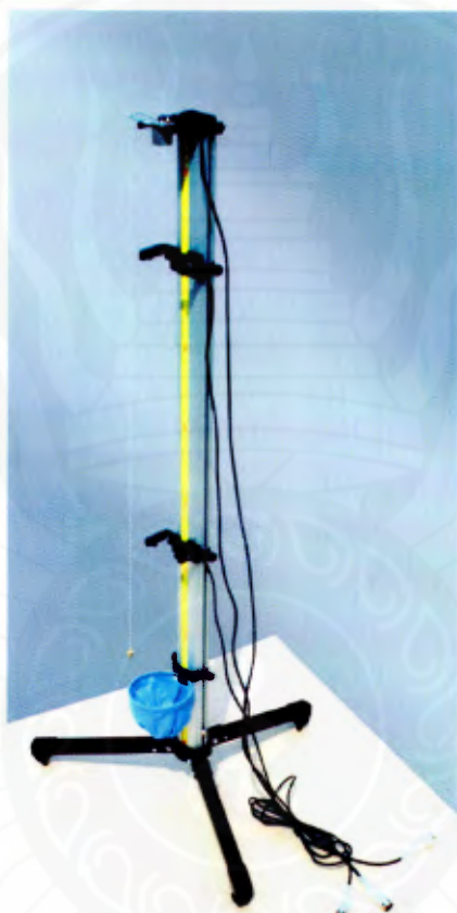
ภาพที่ 2.15 การหาความเร่งโดยใช้เซ็นเซอร์ตรวจจับวัตถุ ที่มา: Free Fall Apparatus (2011)
