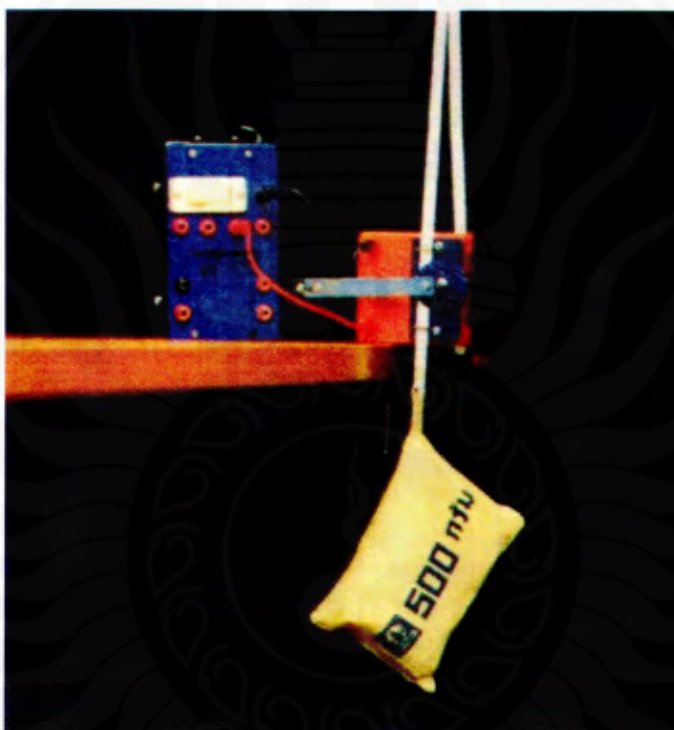
ภาพที่ 2.14 การหาความเร่งโดยใช้เครื่องเคาะสัญญาณเวลา ที่มา: สสวท. (2553)
