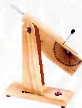
ภาพที่ 2.11 เครื่องยิงวัตถุทำมุมต่างๆ ที่มา - บริษัท แกมมาโก้ (ประเทศไทย) จำกัด (2554, 1)
