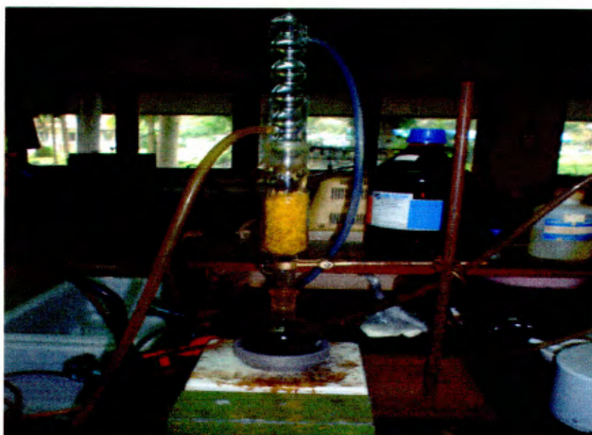
ภาพที่ 7 การสกัดน้ำมันด้วยชุด Soxhlet
