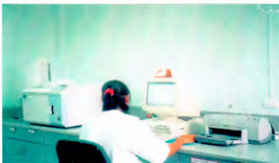
ภาพที่ 3.6 ภาพแสดงเครื่องมือวิเคราะห์ Gas Chromatography ,GC
